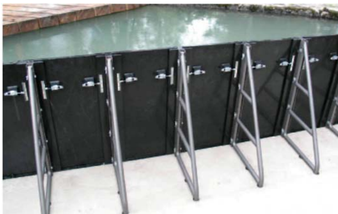
Slika 3. Model Instituta Oskar-von-Miller Tehničkog Univerziteta u Minhenu: ploče za zaštitu od poplave su se dokazale kao stabilne i nepropusne
